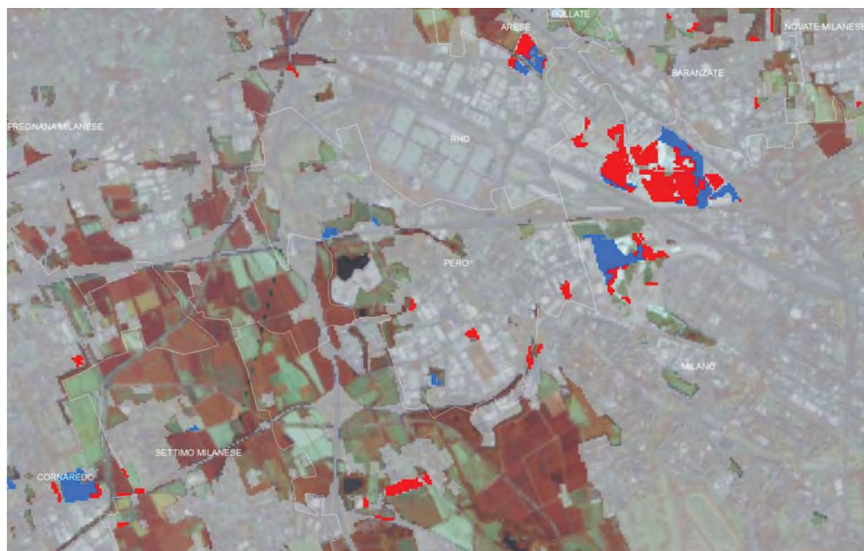
Fig. 14 Dettaglio relativo all'area dell'ovest milanese, della distinzione fra le aree soggette a consumo di suolo fino al 2012 (poligoni blu) e relativi al solo periodo 2012-2013 (poligoni rossi): in questo caso sono evidenti i tratti di nuova edificazione all'interno dell'area EXPO e singole espansioni del tessuto urbano.
