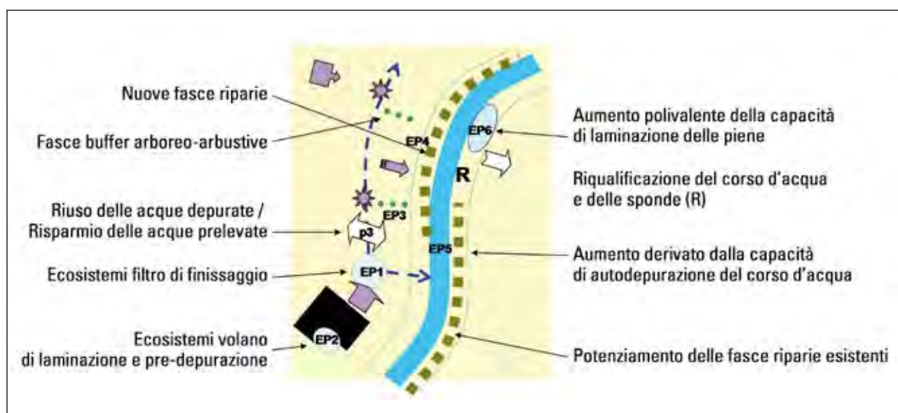
Figura 2.56 – Assetto complessivo polivalente da perseguire per l'integrazione dei corsi d'acqua naturali ed artificiali con il sistema agricolo (da Regione Lombardia DGR 8/10962 - 2010)
