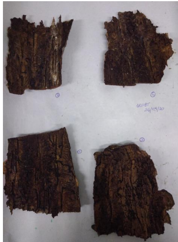
Figura 10: analisi e conteggio delle gallerie in laboratorio
